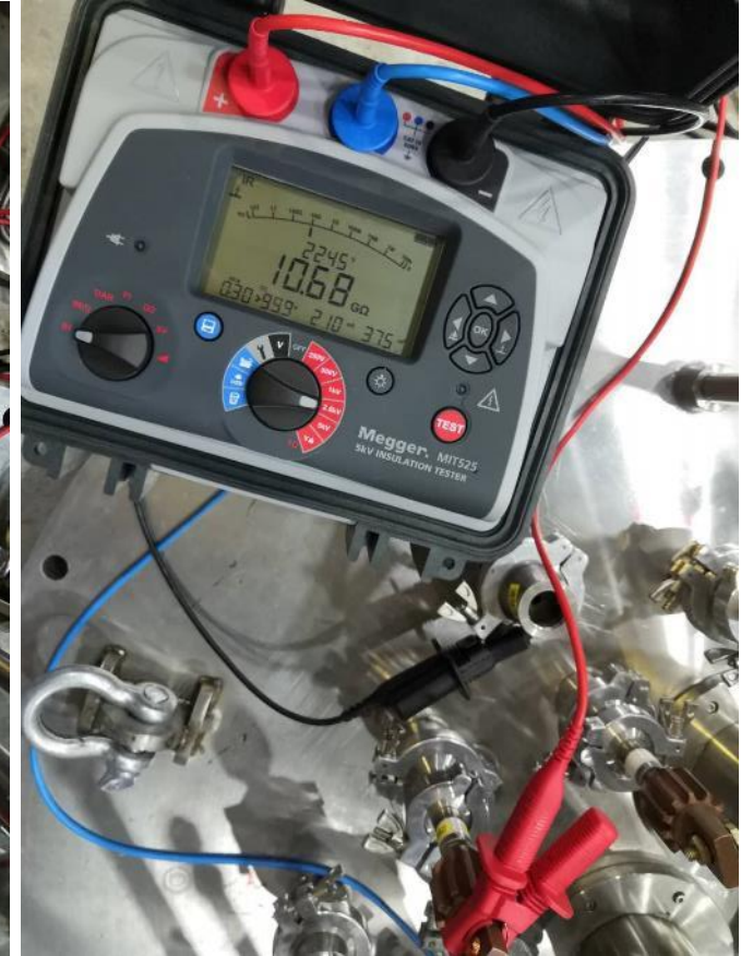
HV test of Aperture V2
