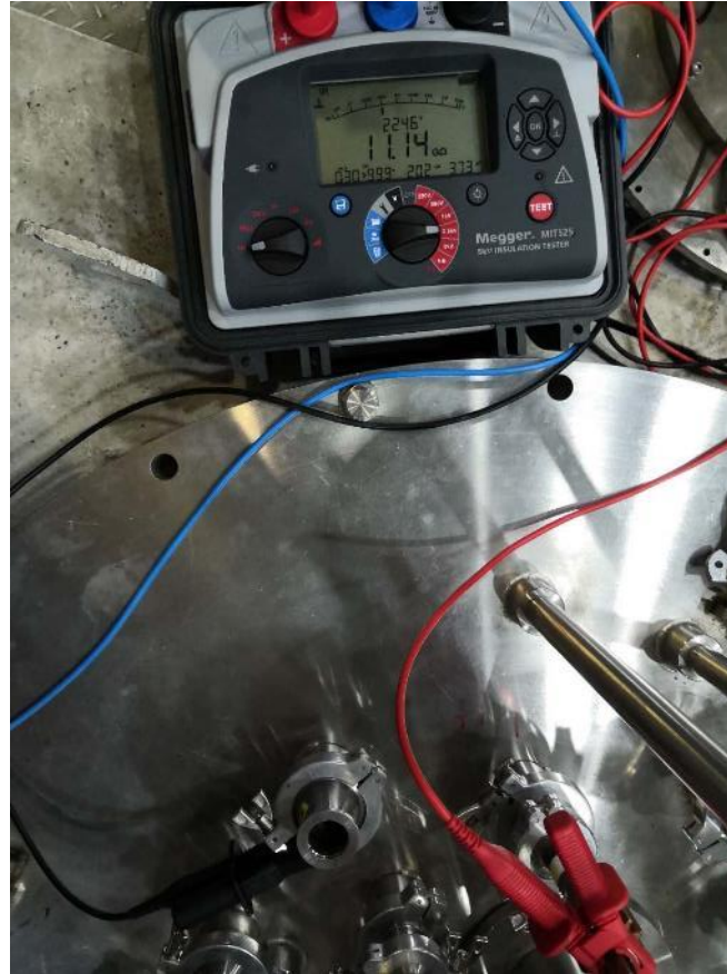
HV test of Aperture V1
