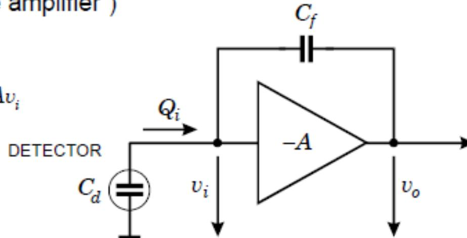
$$\text{so } v_o - v_i = -Av_i - v_i = -(A+1)v_i = -v_f$$
