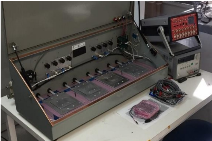
Module Thermal Cycling Box
