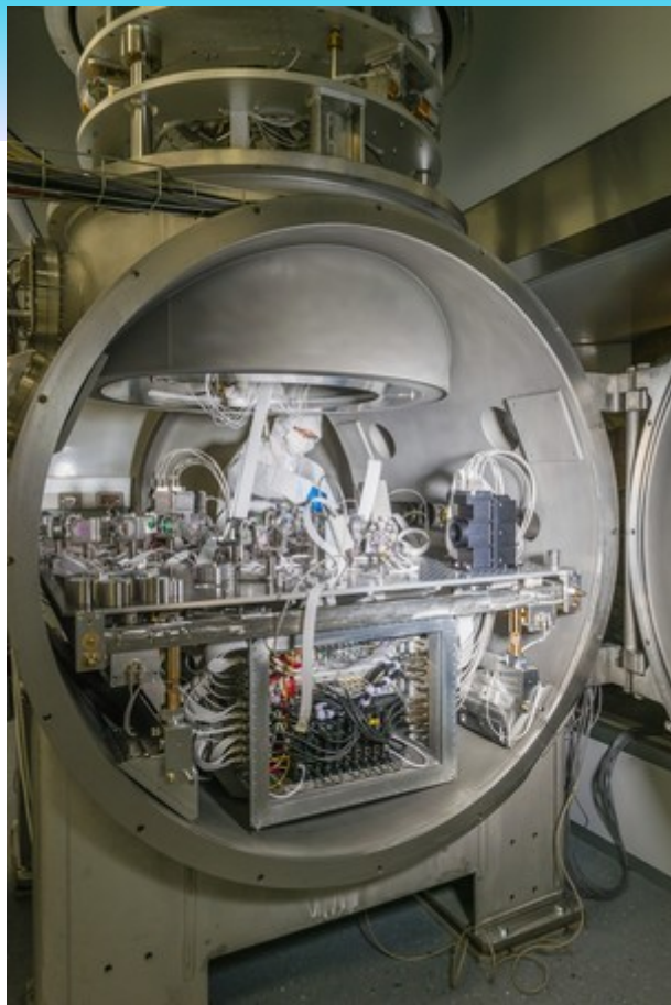
Bancs optiques suspendus sous vide
