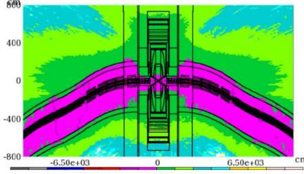
$10^{11} 10^{10} 10^9 10^8 10^7 10^6 10^5 10^4 10^3 10^2 10^1 10^0 10^{-1} 10^{-2} 10^{-3} 10^{-4} 10^{-5}$ Muon flux (cm^-2 s^-1) at |y| < 5 cm
