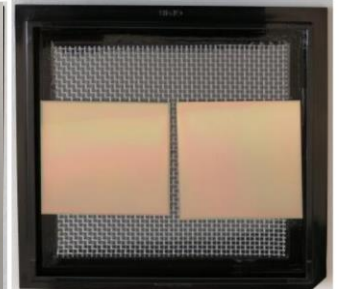
„Quad“ pixel sensor
