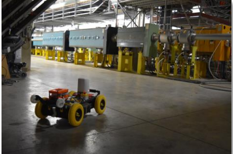
EXTRM robot (CERN made)
